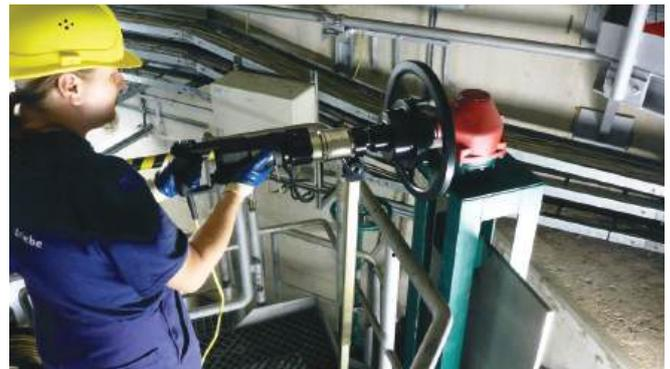
elektrischer Hochmomentschrauber, Ein-Mann-Fußabstützung, Schiebernuss für Handräder Standard-Ausführung
