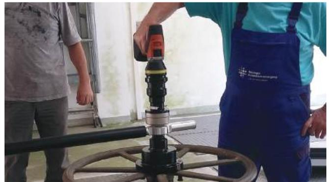
Schieberdrehmaschine, Vorsatzgetriebe, Schiebernuss für Handräder StandardAusführung und doppeltem Abstützhalter inklusive Rohr
