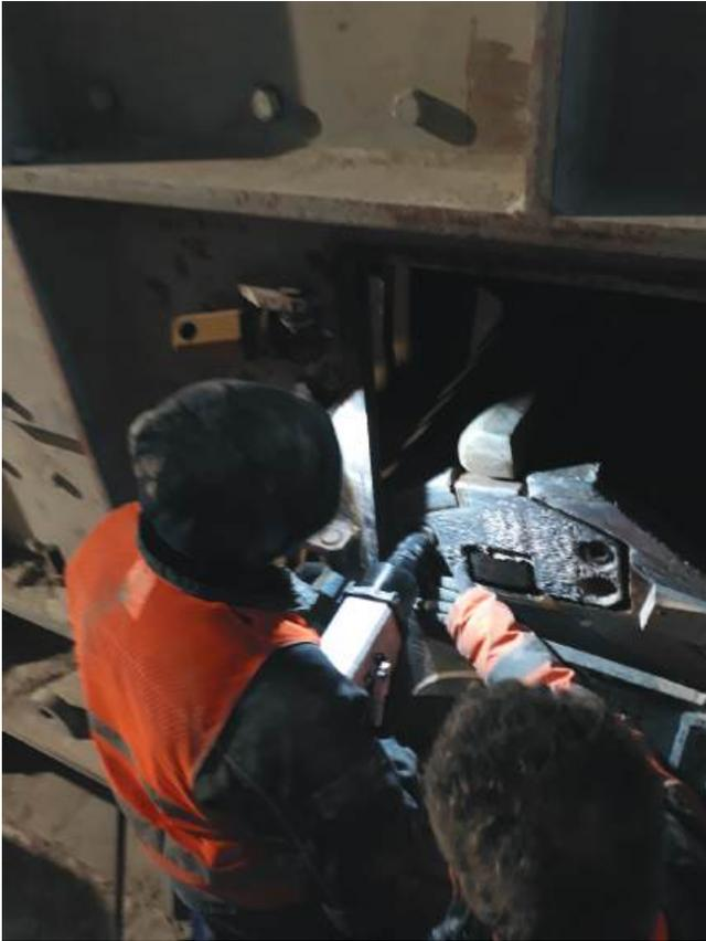
Schlagleistenwechsel mit ca. 1.600 Umdrehungen in der Minute und 5.500 Nm Drehmoment. AKK560
