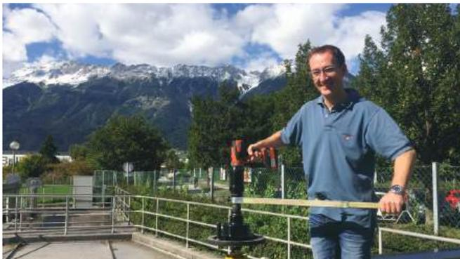
Schieberdrehmaschine, Ein-Mann-Handabstützung, teleskopierbar und Schiebernuss Standard-Ausführung
