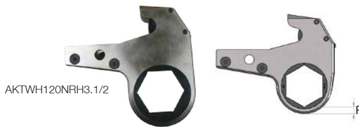
Die AKTWH-NRH Wechselkassetten passend für die AKTWH-N Hydraulikantriebe (siehe Seite 37) bieten eine außergewöhnliche Flexibilität, verfügbar in Standard Schlüsselweiten von 1" bis 6". Alle Modelle sind extrem flach ausgeführt mit minimaler Radiusabmessung für den Einsatz in beengten Raumverhältnissen. Für eine noch größere Vielseitigkeit sind Sechskant- Reduziereinsätze und Umbausätze auf Antriebsvierkant (siehe Seite 39) verfügbar.
