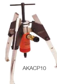
Die hydraulische Abzieher der AKACP "Auto-Centre" Reihe umfassen eine Auswahl von 4 Modellen mit Kapazitäten von 10 bis 50 Tonnen. Alle Modelle werden komplett mit einem abnehmbaren Hohlkolbenzylinder, Handpumpe, Hydraulikschlauch und einem 100 mm Durchmesser Manometer geliefert. Alle Modelle sind einfach einzurichten. AKACP Abzieher sind das ideale Werkzeug für Auf- und Abzieharbeiten von Räder, Ritzel, Schwungräder, Zahnräder und Lager, welche unter Druck oder Hitze installiert wurden.
