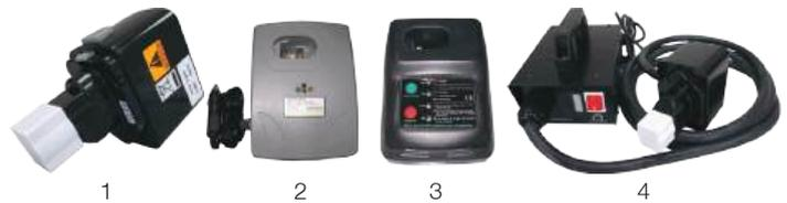
Die AKBBP107 Akku-Hydraulikpumpe wurde für den mobilen Einsatz entwickelt (nur 6,6 kg) und wird von einem leistungsfähigen 14.4V Akku angetrieben. Die Pumpe besitzt ein automatisches Sicherheits- und Ablassventil, welches den Druck automatisch entlastet, wenn die Pumpe ihren maximalen Druck von 700 bar erreicht. Damit ist die Pumpe ideal für den Einsatz mit den Hi-Force Reihen AKCH Presswerkzeuge, AKNS Mutternsprenger, AKHCH Schneider und AKHKP Lochstanzer.
