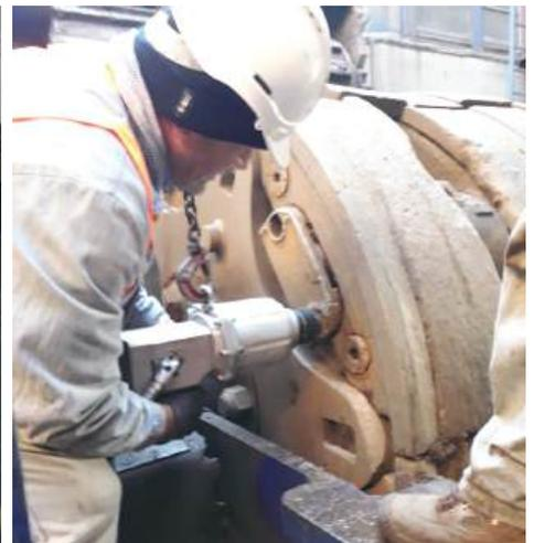
Schlaghammerwechsel bei einem Recyclingschredder mit 6000 PS. AKK1600. 16.000 Nm
