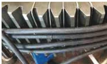
Flexible Induktoren können sowohl im Werkstück als auch um das Werkstück herum angebracht werden
