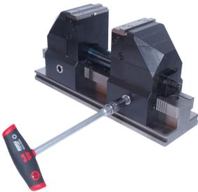
Gesamtbacken-Verstellung mittels Teil 1 Handschlüssel und Teil 5 Aufsatz SW 12 Außensechskant. Gewinde Stift ca. 3mm herausdrehen dann Backe auf die gewünschte Skalierung verschieben und wieder anziehen.
