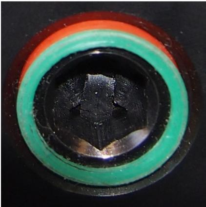
Gewindestift ca. 3-4 mm herausdrehen, bis rot sichtbar dann Backe verschieben .....Eindreihen bis rot nicht mehr sichtbar, dann ist die Backe fest.
