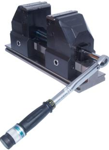
Spannen mittels Teil 2 Drehmomentschlüssel, und Teil 4 Langer Aufsatz SW13, nicht über 60Nm einstellen.
