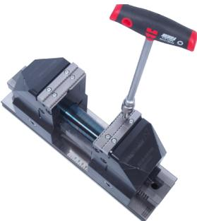
Spannbacke wechseln , mittels Teil 1 Handschlüssel und Teil 6 Aufsatz SW 4 Außensechskant Schrauben DIN 912 10.9, 2x M5x10 + 2x M5x12
