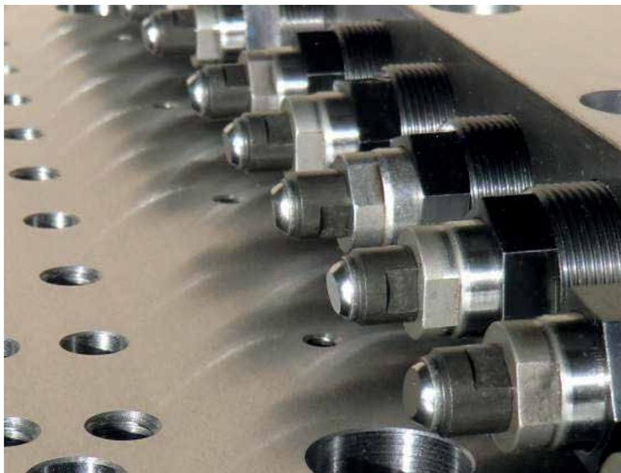
Praxisbeispiel: Mehrfach-Spannvorrichtung für die Serienfertigung verschiedener Werkstücke (z. B. Flanschplatten). Die Vorrichtung findet Einsatz in einem Drehtisch. Die Spannlänge beträgt 600 mm. Zum Einsatz kommen 48 St. EZY-EM-020-015 und eine gesteuerte Drehdurchführung DRG-5-EW-06-002.
