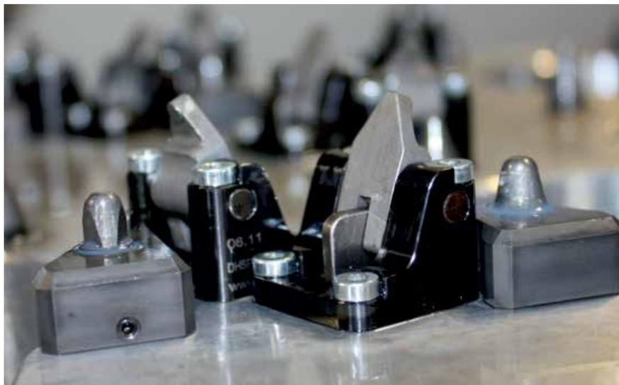
Einbaubeispiel: Mehrfachspannvorrichtung mit doppelt wirkenden Dreh-Hebelspannern mit Kolbendurchmesser 12 mm. Weitere Informationen und Abbildungen hierzu auf Seite 6
